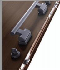
『ジェスタ』の玄関ドアは、ピッキング対策に効果的な2ロックを標準装備。さらに、上部ロックに2つ、下部ロックに1つ、鎌付デッドボルトを採用することで、「こじ破り」に対する抵抗力を高めています。
